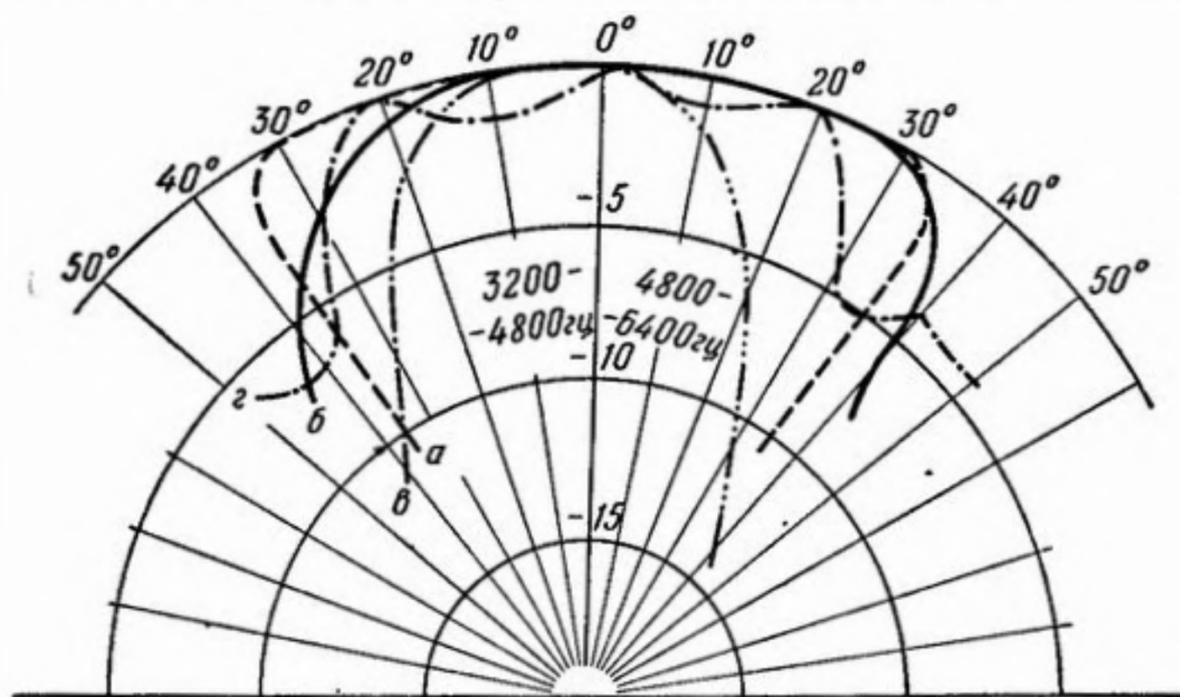
Фиг. 3. Характеристики направленности высокочастотного излучателя громкоговорителя 30А-3:
