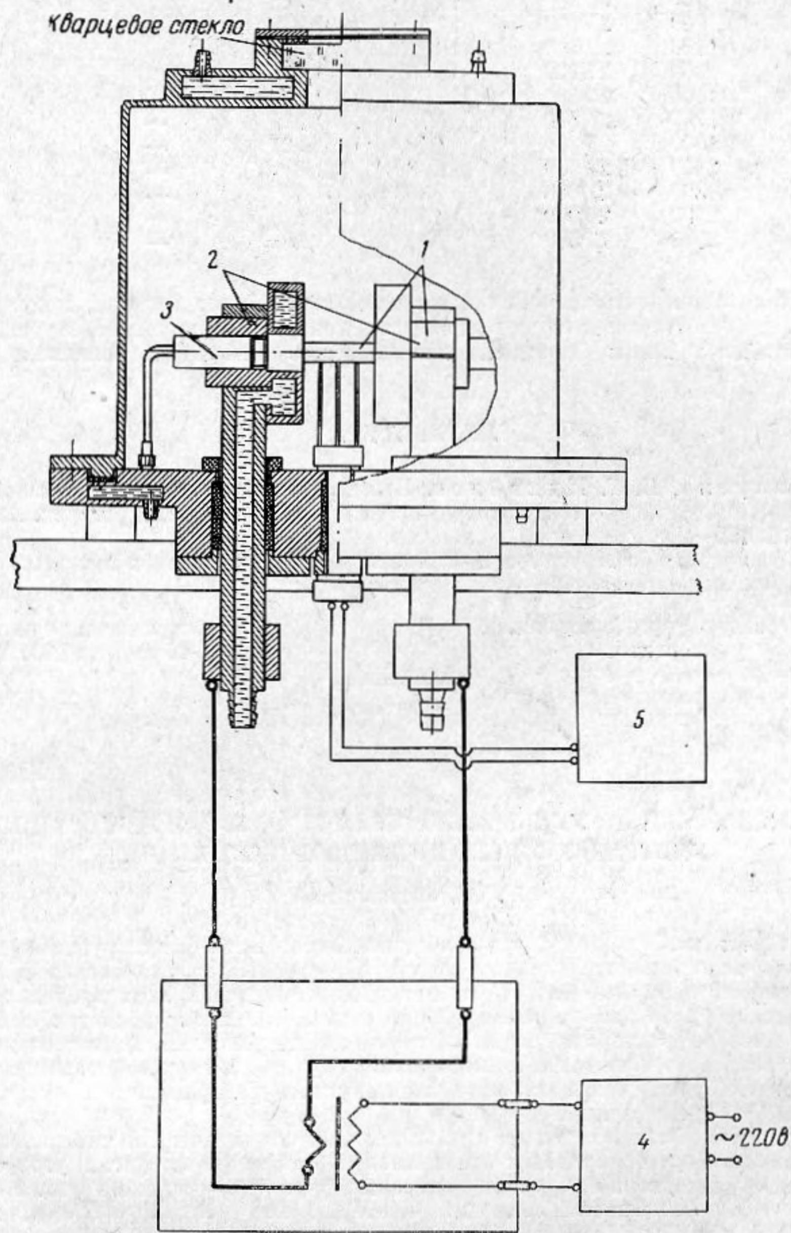
13 квА, напряжение на вторичной обмотке 2—4 в. При токах порядка 6000—6500 А легко удается довести до плавления образцы из молибдена и вольфрама диаметром 12 мм и длиной 50 мм.
