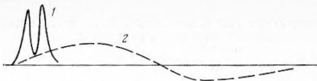
Фиг. 2. Схема формирования профиля сигнала в условиях сильного испарения. 1 — импульс термооптической генерации звука; 2 — импульс испарительной генерации звука
