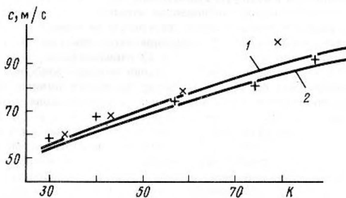
Зависимость скорости звука в газожидкостной пене от кратности: +, X – экспериментальные значения скорости звука соответственно в водовоздушной и водогелиевой пенах. Кривые 1, 2 – теоретические зависимости, построенные по дисперсионному уравнению из [2] соответственно для водогелиевой и водовоздушной пен
