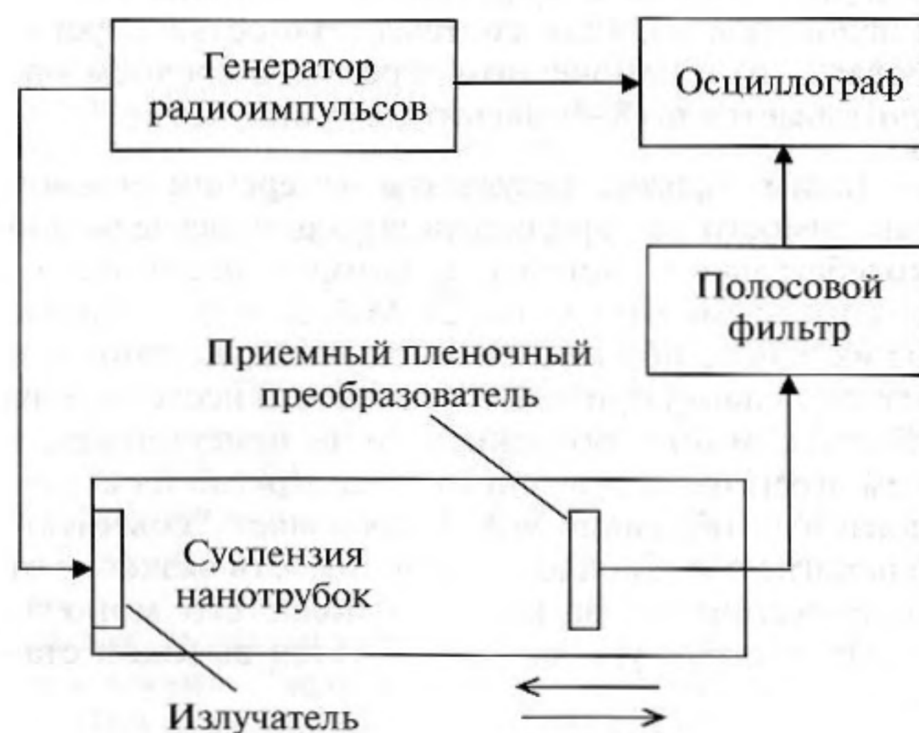
Рис. 1. Блок-схема установки для измерения коэффициента поглощения.
