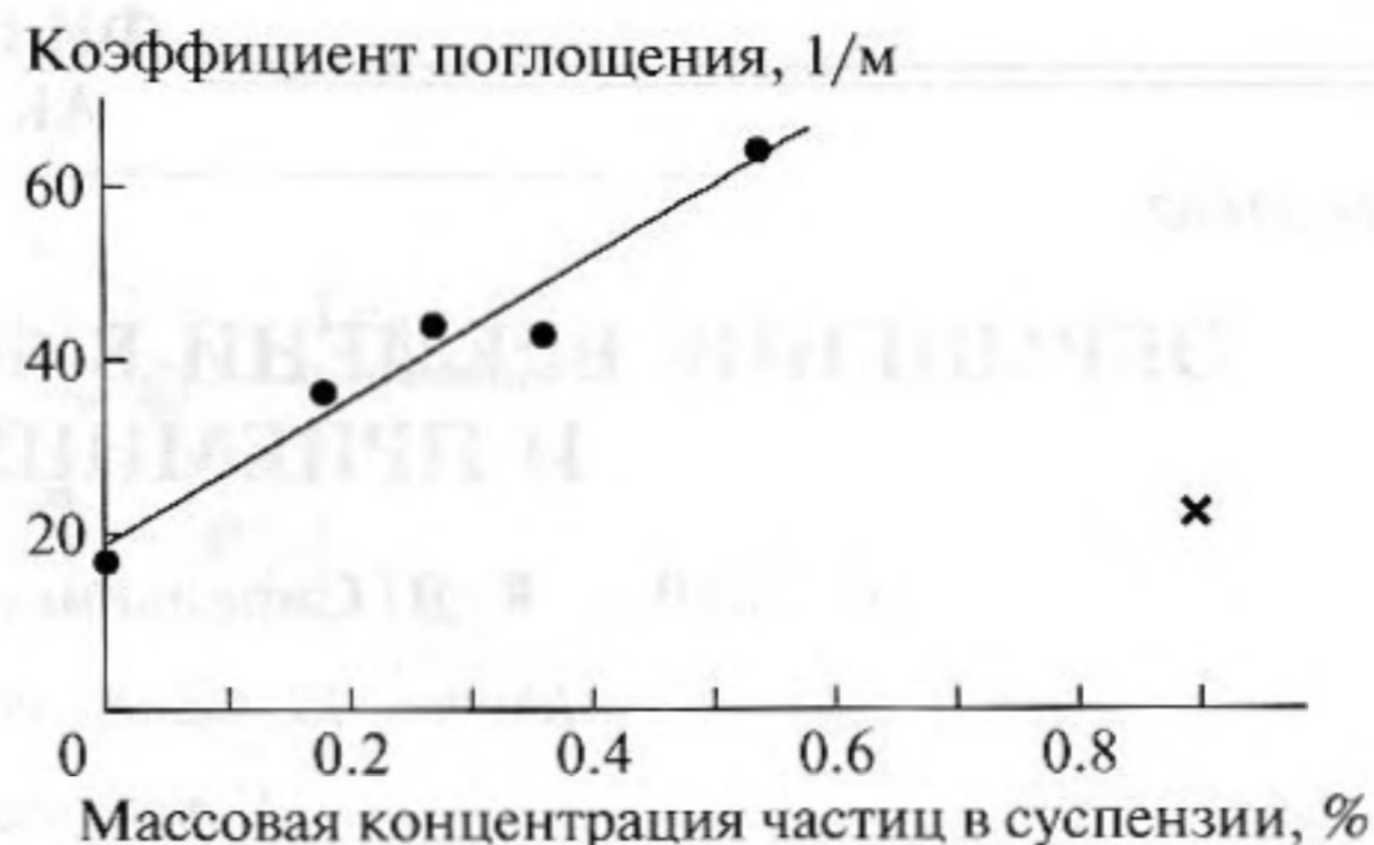
Рис. 3. Зависимость коэффициента поглощения ультразвука (1/м) в суспензии нанотрубок на частоте 3 МГц от их массовой концентрации (в процентах). Крестиком помечено значение коэффициента поглощения для суспензии мелкодисперсной сажи.
