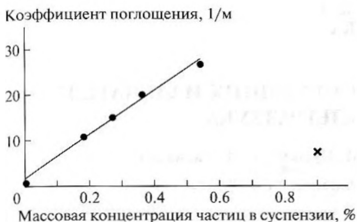
Рис. 2. Зависимость коэффициента поглощения ультразвука (1/м) в суспензии нанотрубок на частоте 9 МГц от их массовой концентрации (в процентах). Крестиком помечено значение коэффициента поглощения для суспензии мелкодисперсной сажи.
