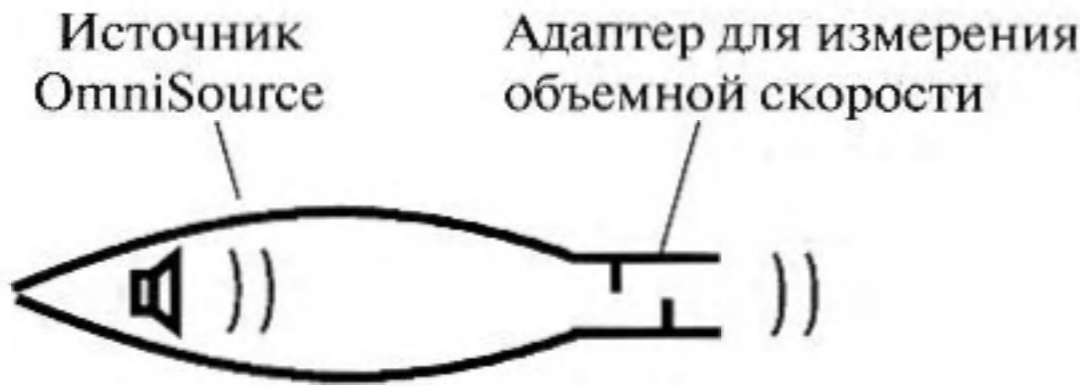
Рис. 2. Схема источника с адаптером для измерения объемной скорости на выходе из источника.
