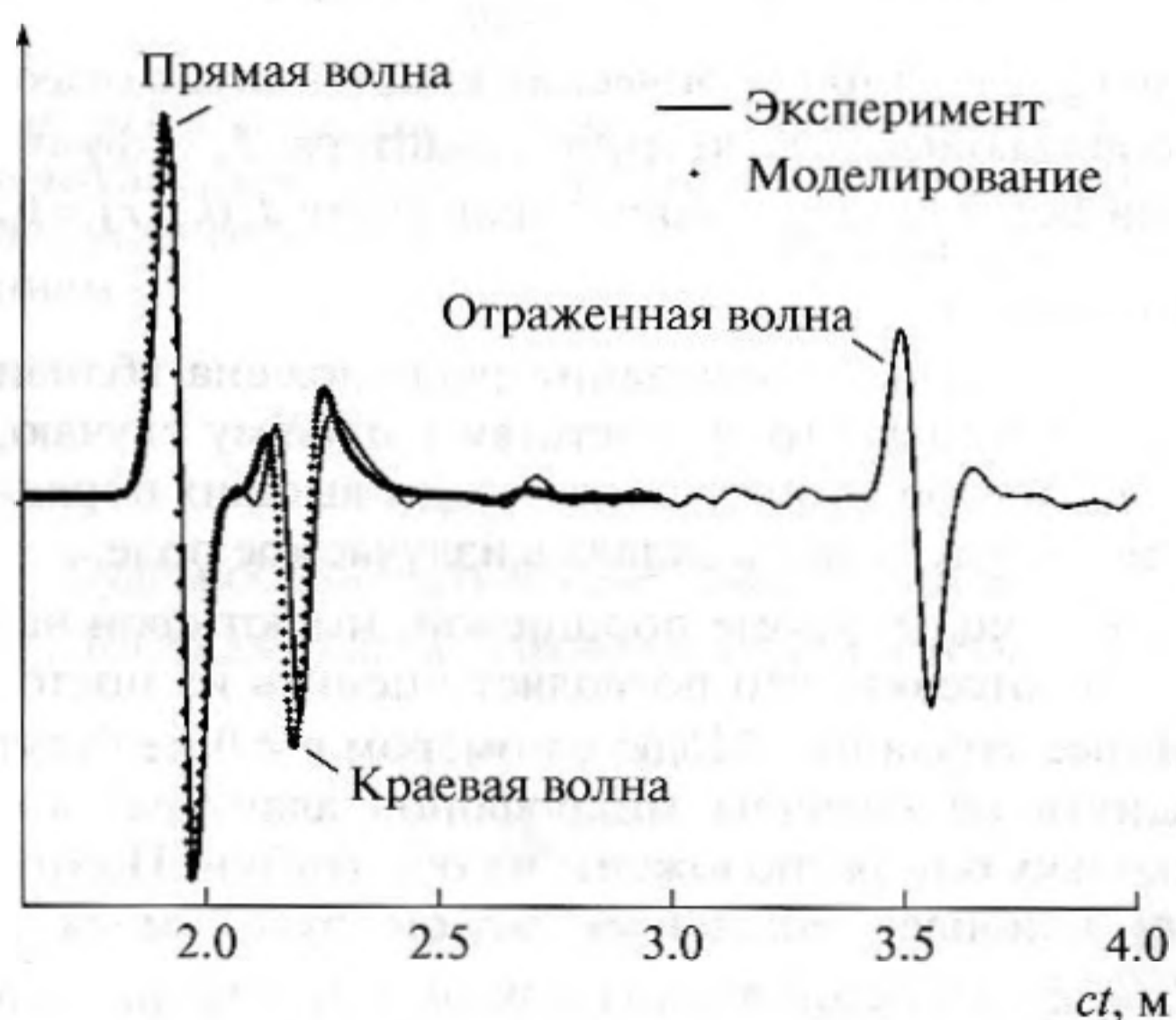
Рис. 7. Измеренная импульсная функция H^{\text{prop}}(t) в сравнении с результатами численного моделирования.
