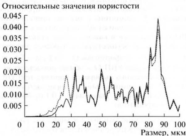
Рис. 3. Распределения относительных значений пористости. Пунктир – первое приближение, сплошная линия – второе приближение.
