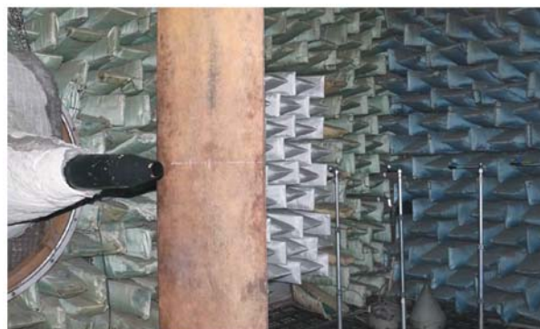
Рис. 2. Общий вид экспериментальной установки для исследования экранирования шума одноконтурной струи в акустической камере АК-2.
