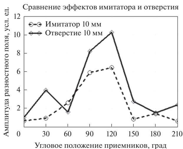
Рис. 1. Сравнение угловых распределений амплитуд разностных сигналов за отверстием и имитатором.
