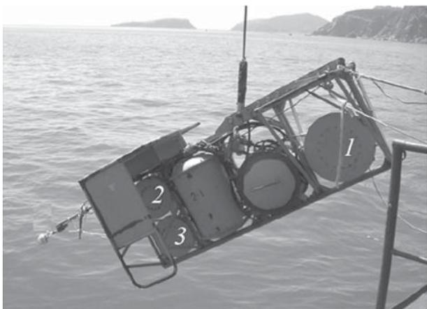
**Рис. 3.** Излучающий комплекс перед спуском на воду. В центре расположены бак противодавления и контейнер с компьютером и часами. Излучатели 1, 2 и 3 соответствуют частотам 117, 320 и 680 Гц. Пинг-пер закреплен вблизи штанги.
