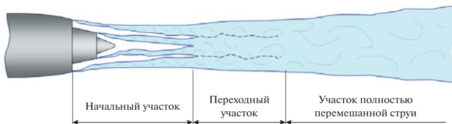
Рис. 3. Схематичное изображение характерных участков течения в струе, истекающей из двухконтурного сопла.
