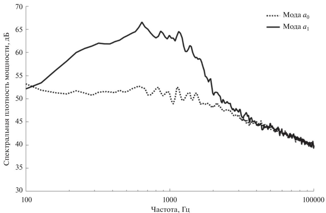
Рис. 11. Спектры продольного (мода  $a_0$ ) и поперечного (мода  $a_1$ ) диполей, полученные с помощью азимутального разложения звукового поля в плоскости задней кромки пластины.
