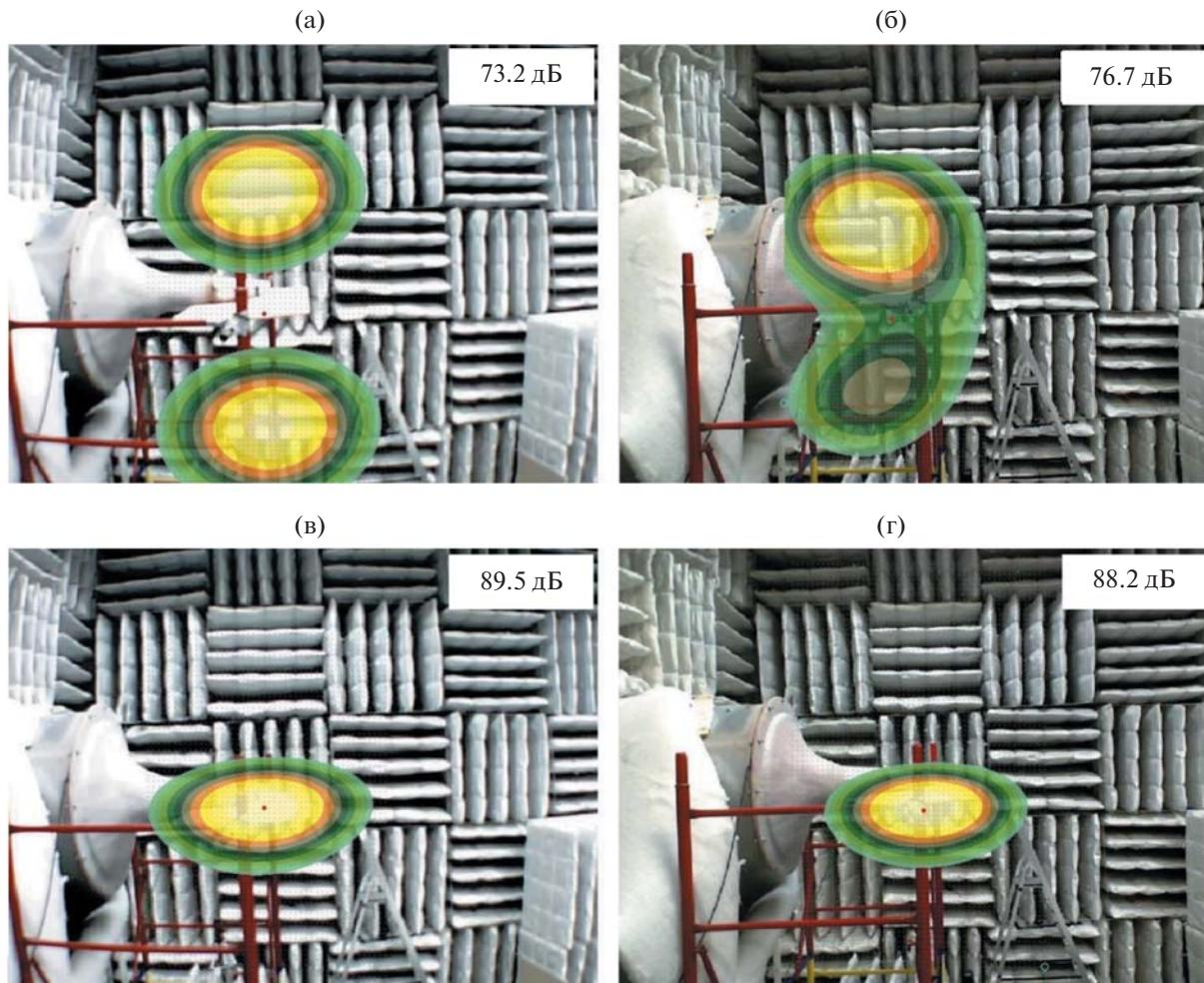
**Рис. 13.** Локализация источников шума взаимодействия потока и задней кромки тонкой пластины с помощью двух микрофонных антенн: (а), (б) – монопольный алгоритм; (в), (г) – дипольный алгоритм.
