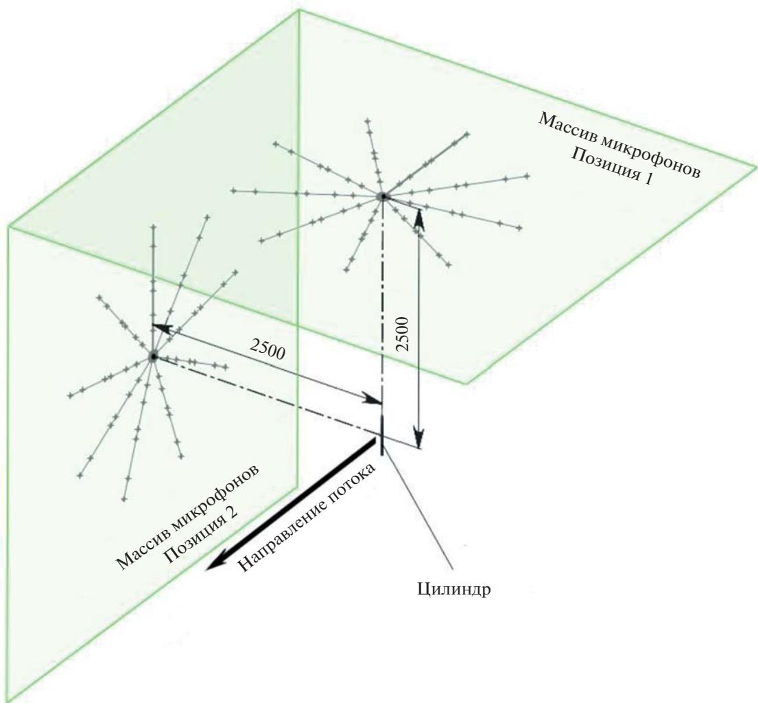
Рис. 3. Ориентация микрофонных антенн относительно металлического стержня.
