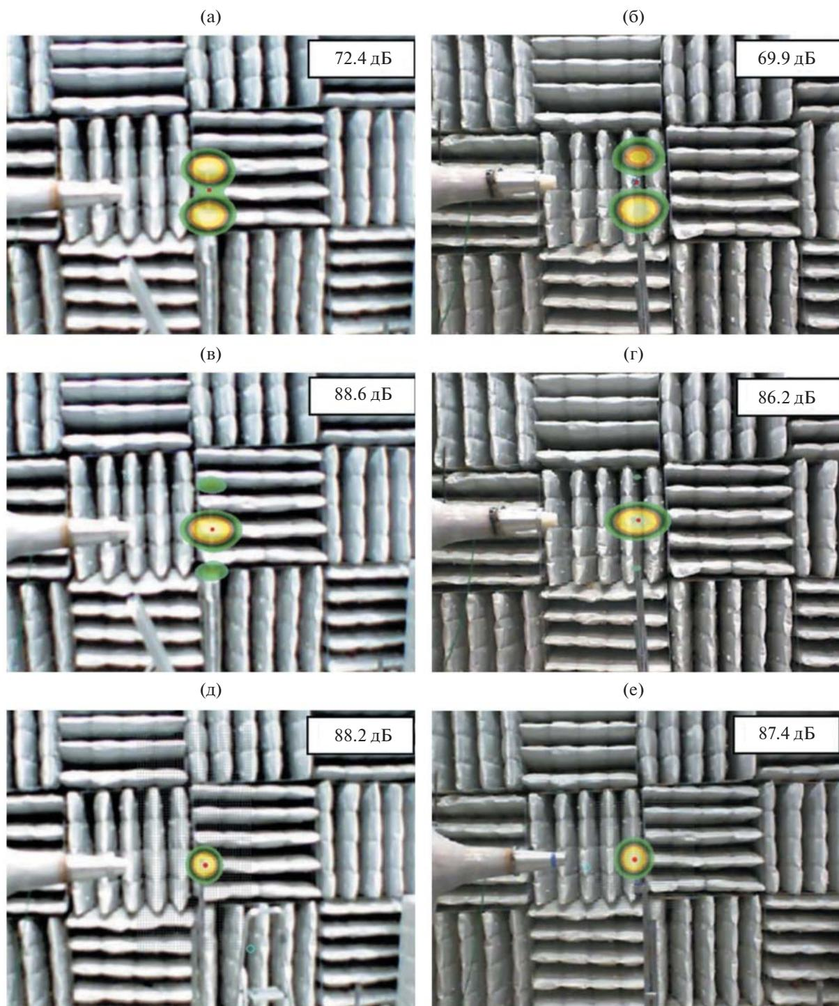
**Рис. 8.** Локализация шума обтекания цилиндра с помощью двух микрофонных антенн: (а), (б) – монопольный алгоритм, антенны в позиции 1; (в), (г) – дипольный алгоритм, антенны в позиции 1; (д), (е) – монопольный алгоритм, антенны в позиции 2.
