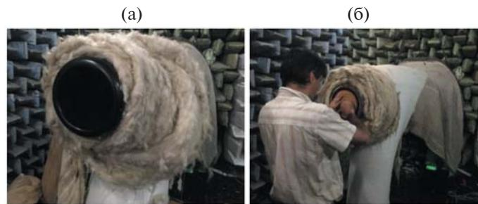
**Рис. 6.** Фотографии модели воздухозаборника с использованием звукопоглощающих и вибропоглощающих материалов на боковых стенках воздуховода: (а) – с открытым концом канала, (б) – с закрытым концом канала жесткой стенкой из вибропоглощающего материала.
