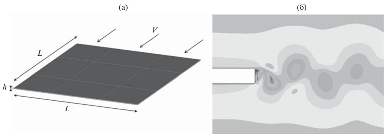
Рис. 2. К постановке гидродинамической задачи об обтекании пластины.
