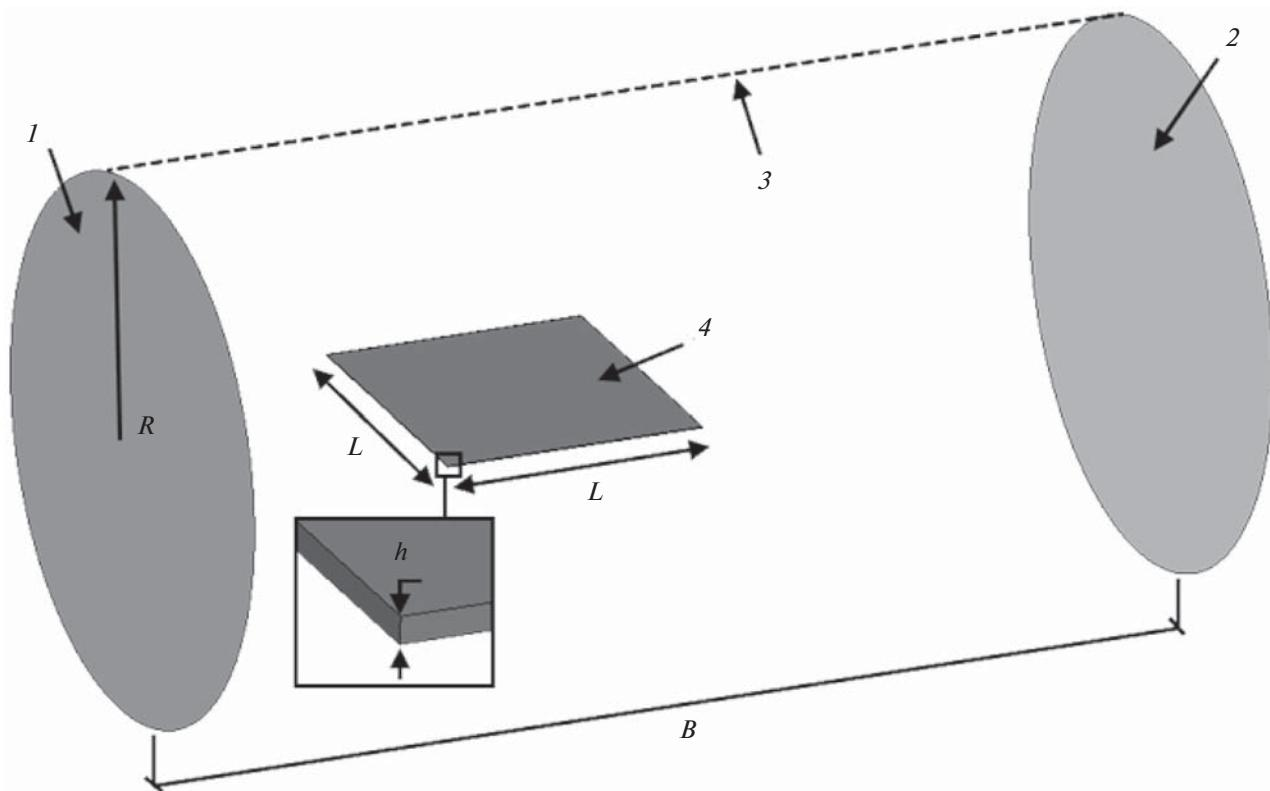
Рис. 1. Расчетная область гидродинамической задачи об обтекании пластины.
