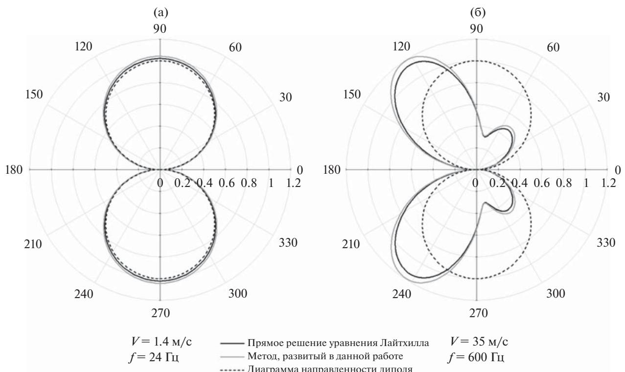
Рис. 3. Угловая зависимость нормированного звукового давления  $p/p_d$  в плоскости, проходящей через перпендикуляр к центру пластины. (а) – Скорость потока 1.4 м/с, частота 24 Гц. (б) – Скорость потока 35 м/с, частота 600 Гц.
