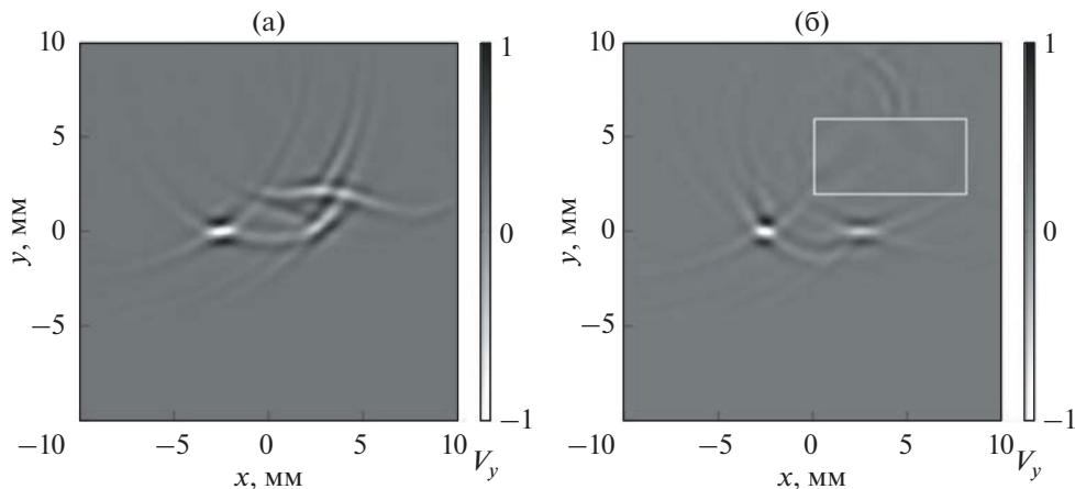
**Рис. 4.** Восстановленное изображение двух изотропных источников в неоднородной среде (а) – без учета неоднородности и (б) – с учетом неоднородности (белым прямоугольником показана неоднородность), визуализирована вертикальная компонента скорости частиц.
