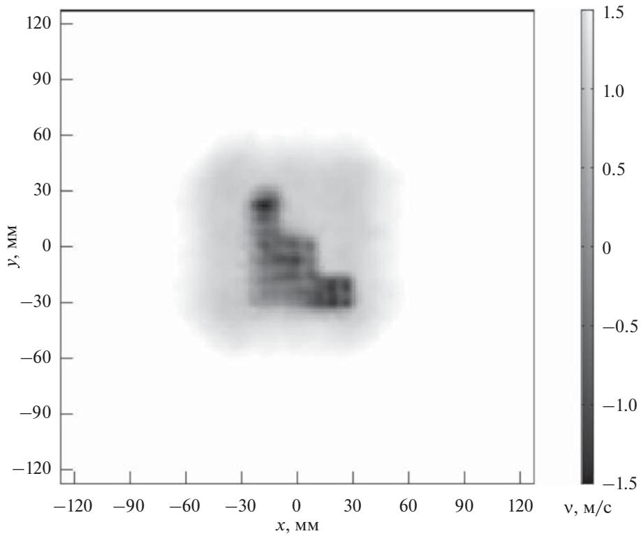
**Рис. 10.** Результат восстановления изображения отверстия в звуконепроницаемом экране методом обращения времени в модели частиц.
