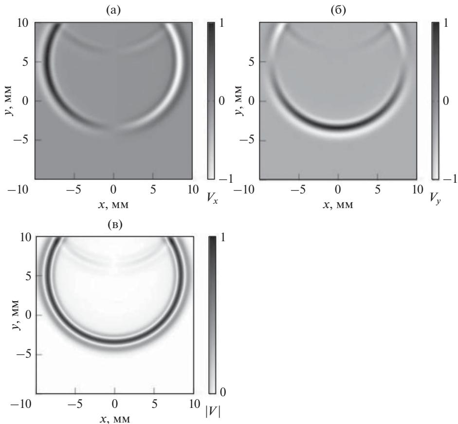
**Рис. 3.** Моделирование согласованной границы. Показано поле скоростей цилиндрической волны в жидкости. (а) – Компонента скорости по оси  $x$ , (б) – компонента скорости по оси  $y$ , (в) – модуль вектора скорости. При нормальном падении волна не отражается.
