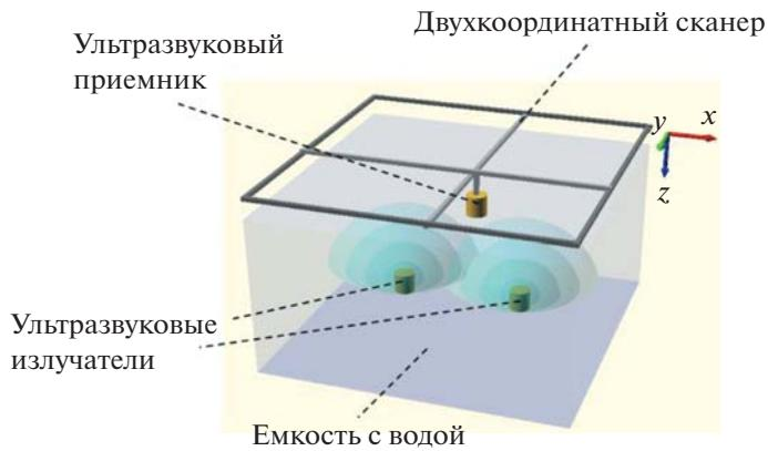
Рис. 5. Схема измерения поля ультразвуковых излучателей через воду.
