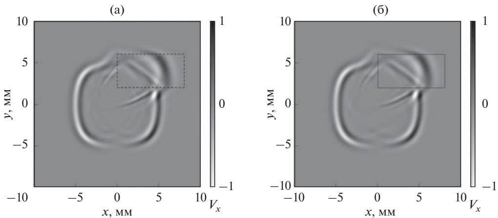
**Рис. 2.** Распределение горизонтальной компоненты скорости частиц для короткого импульса в пластине германия с неоднородным прямоугольным включением из кремния. (а) – Метод динамики частиц, (б) – COMSOL Multiphysics 5.3a: Solid Mechanics, Linear Elastic Material, Solid model – Anisotropic.
