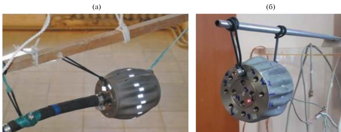
Рис. 7. Излучатели “3D НЧИ” ((а) – № 1, (б) – № 2) в сборе, закрепленные на эластичном подвесе.
