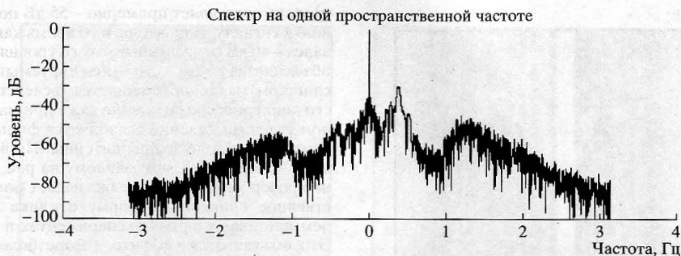
Рис. 9. Спектр отклика антенны на одной пространственной частоте (угловой координате), соответствующей максимальному угловому сдвигу имитированного рассеивателя (рис. 6б). Прямое поле не затемнялось.
