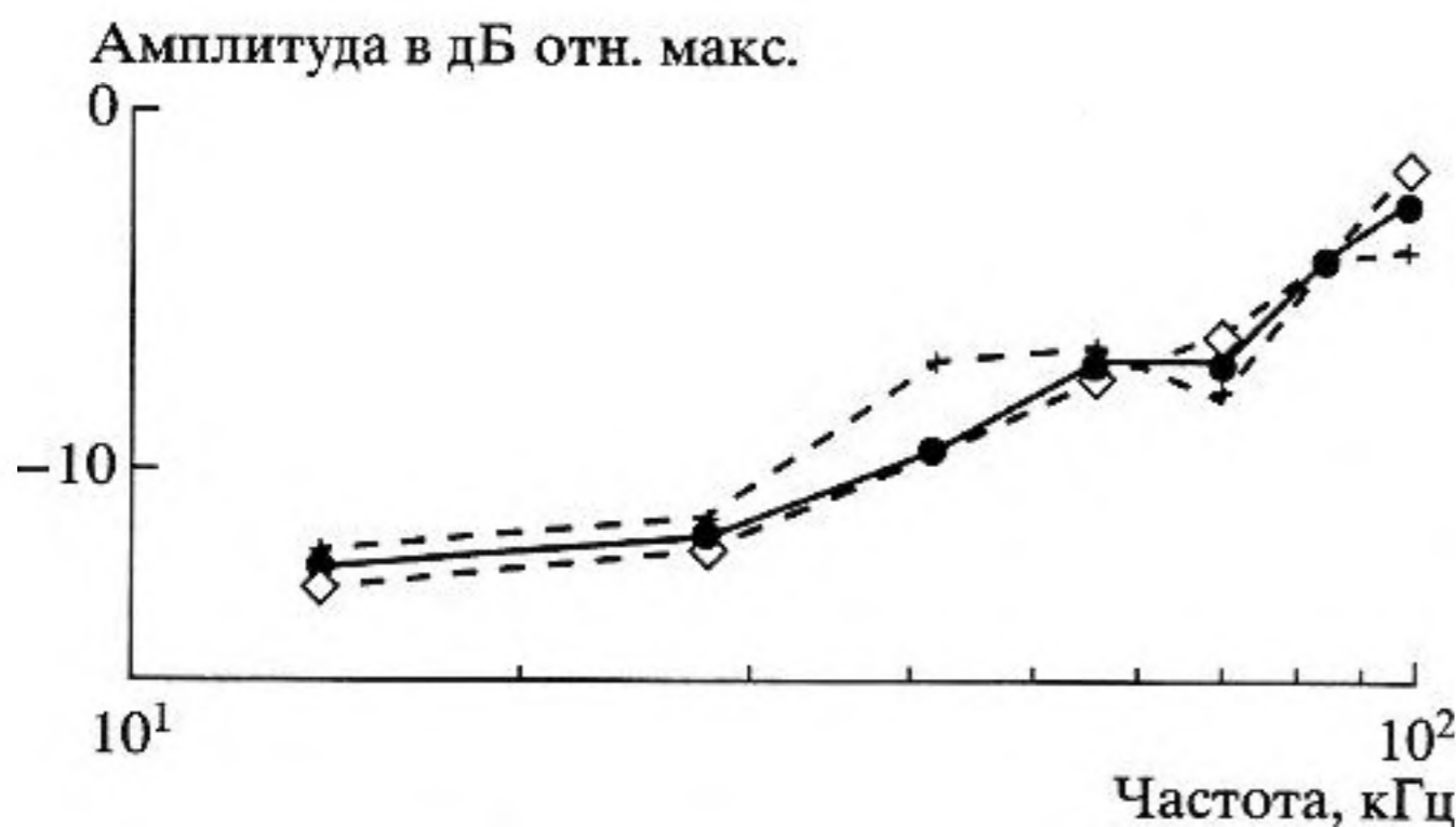
Рис. 3. Спектрограммы импульсов, зарегистрированных в воде с разных излучателей (пунктир) в ответ на один и тот же электрический импульс. Сплошная линия – усредненная спектрограмма для обоих излучателей.
