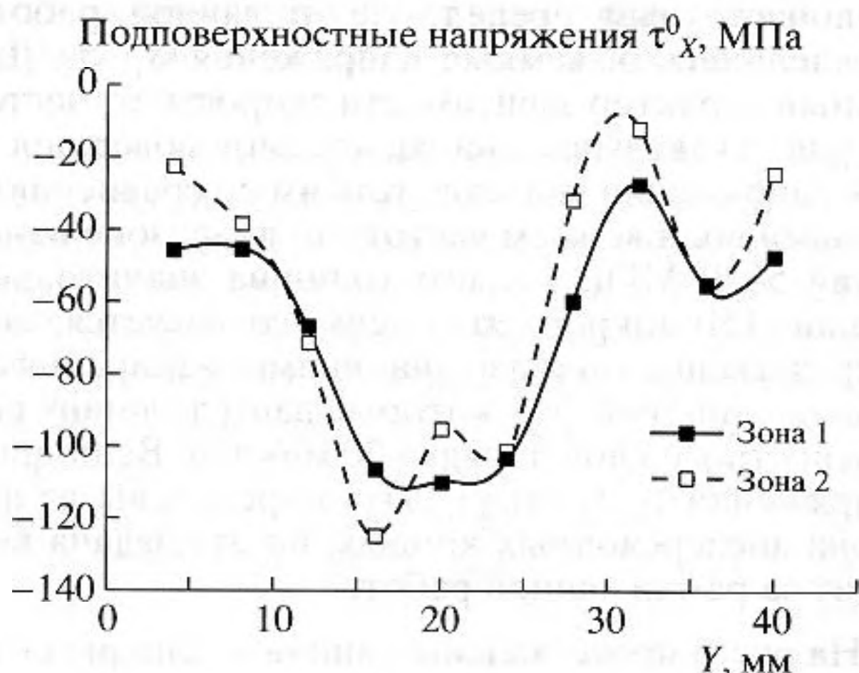
Рис. 4. Усредненное по глубине распределение поверхностных напряжений \tau_x в образце.
