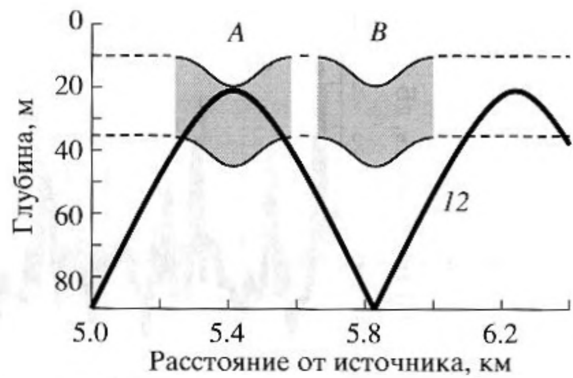
Рис. 4. Невозмущенный луч 12 (критический луч) и два положения солитона: А – максимальное взаимодействие луча с солитоном, В – отсутствие взаимодействия.
