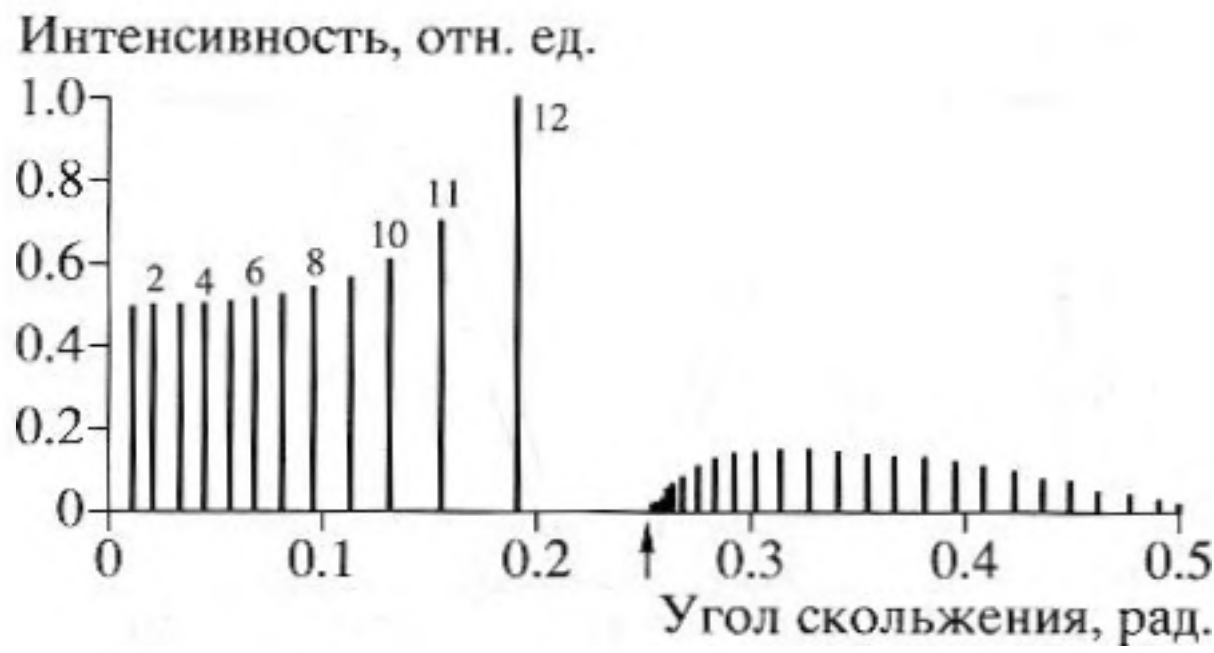
Рис. 3. Угловой спектр принимаемых лучей в отсутствие ВС. Стрелкой показан угол \chi_{cr1} полного внутреннего отражения от верхней границы термоклина.
