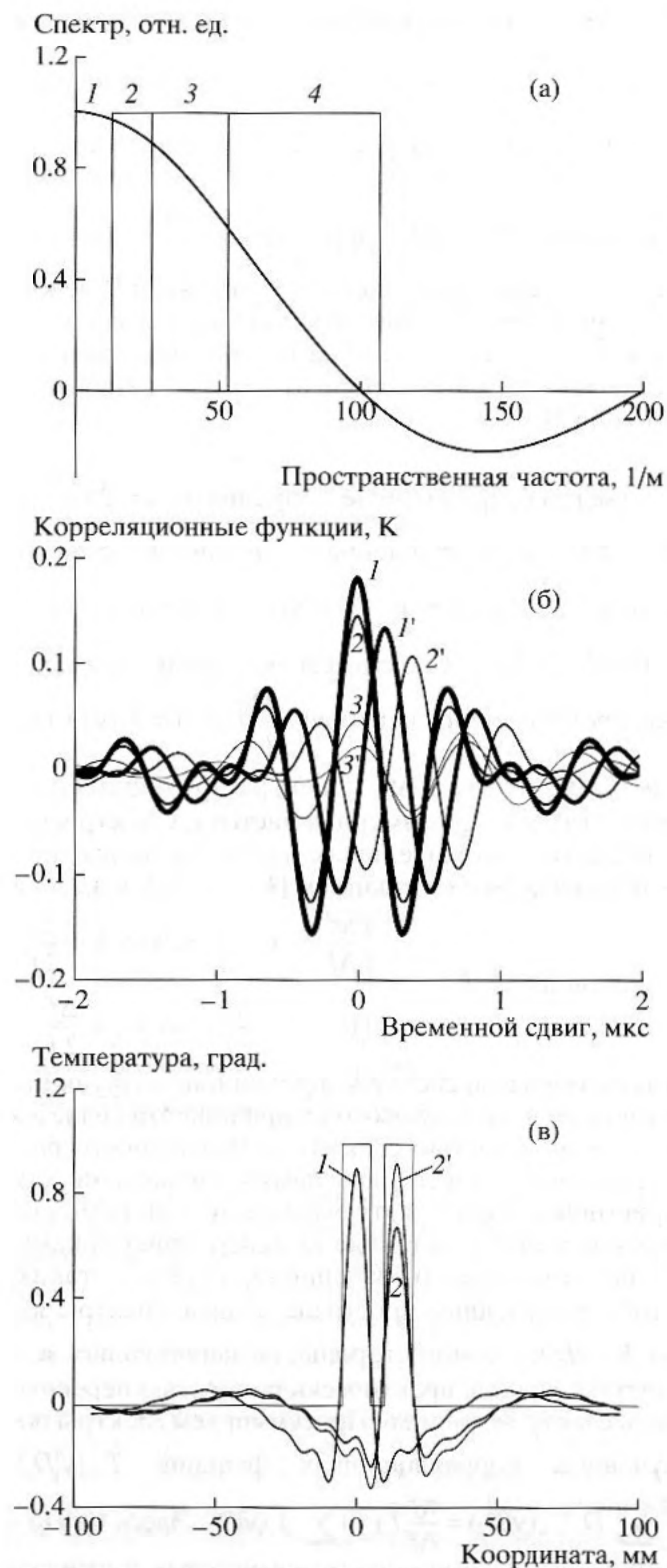
Рис. 2. Компьютерное моделирование восстановления температурного распределения. (а) – Спектры источника (1) и ядра уравнения при трех значениях расстояния между приемниками: D = 1 см (2), 2D (3), 4D (4). (б) – Корреляционные функции от источников с центрами x = 0 (1–3) и 1.5 см (1'–3') при трех значениях расстояния между приемниками. (в) – Заданные и восстановленные температурные распределения для двух тепловых источников: (1) x = 0 ; (2) x = 1.5 см, 2' – распределение, уточненное с помощью выражения (3).
