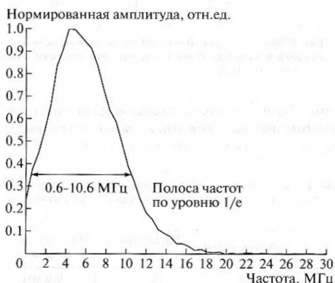
Рис. 3. Спектр одного из экспериментально зарегистрированных отдельным приемником ОА сигналов.
