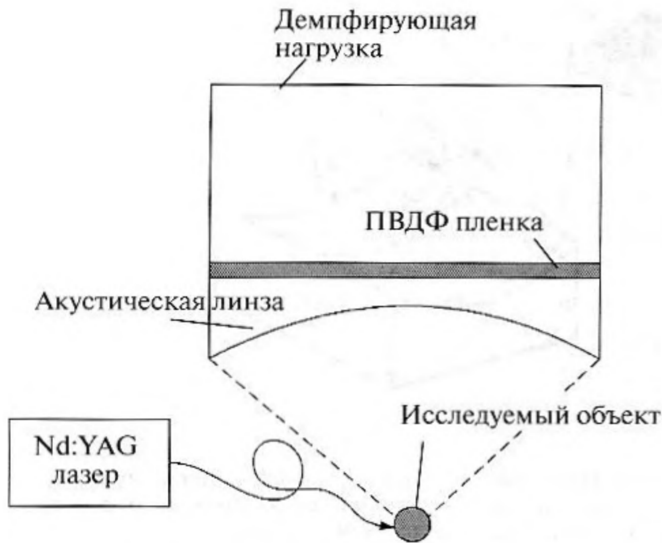
Рис. 2 Схема расположения элементов в антенне.
