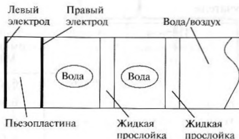
Рис. 1. Геометрия ультразвуковой камеры.
